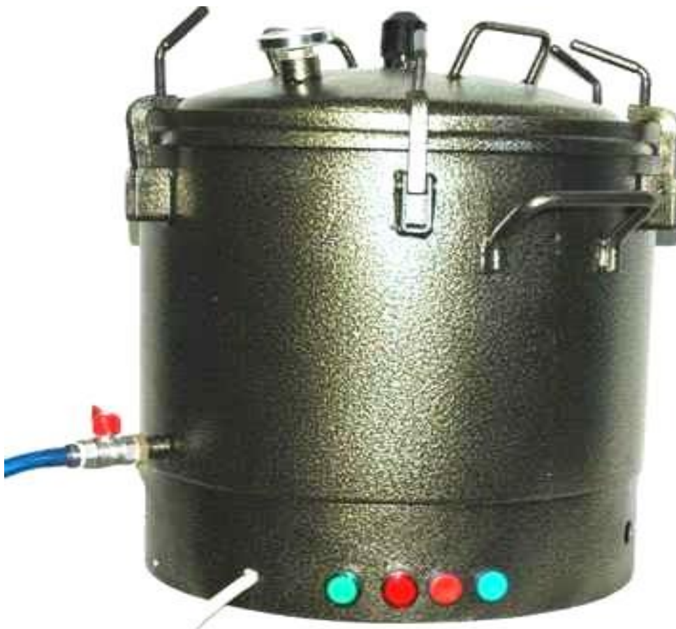
2.2.6-расм. Компот солинган бонкаларни стерилизация қилувчи ускуна (автоклав)
