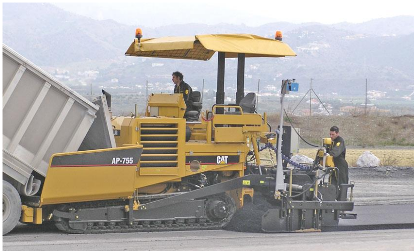
Caterpillar AP 600 маркали гусеничали юргичли асфальт ёткизгич машинаси
