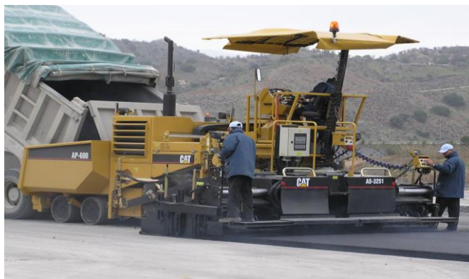
Caterpillar AP 600 маркали гилдиракли юргичли асфальт ёткизгич машинаси
