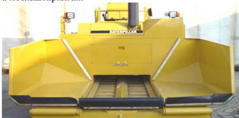
Catarpellar AP 600 маркали асфальт ёткизгич машинаси, асфальт қабул килул қилувчи бункери
