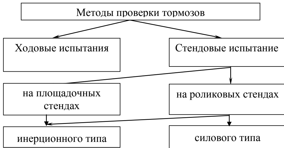
Рис. 18. Классификация методов проверки тормозов транспортных средств.
