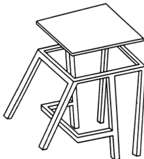
1.2.2-расм. Олти устунли химояловчи каркас.
