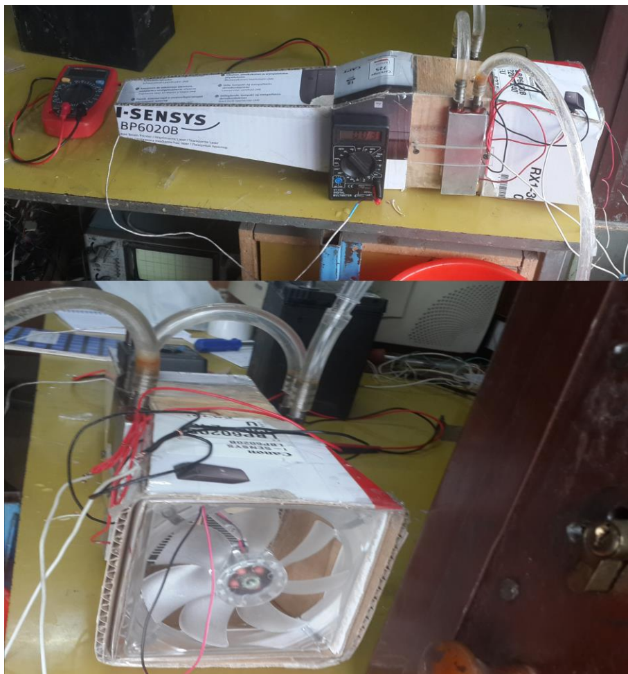
17-расм. Яратилган автомобил салонини совитиш-иситиш курилмасининг тажриба ўтказиш учун йиғилган конструкцияси.
