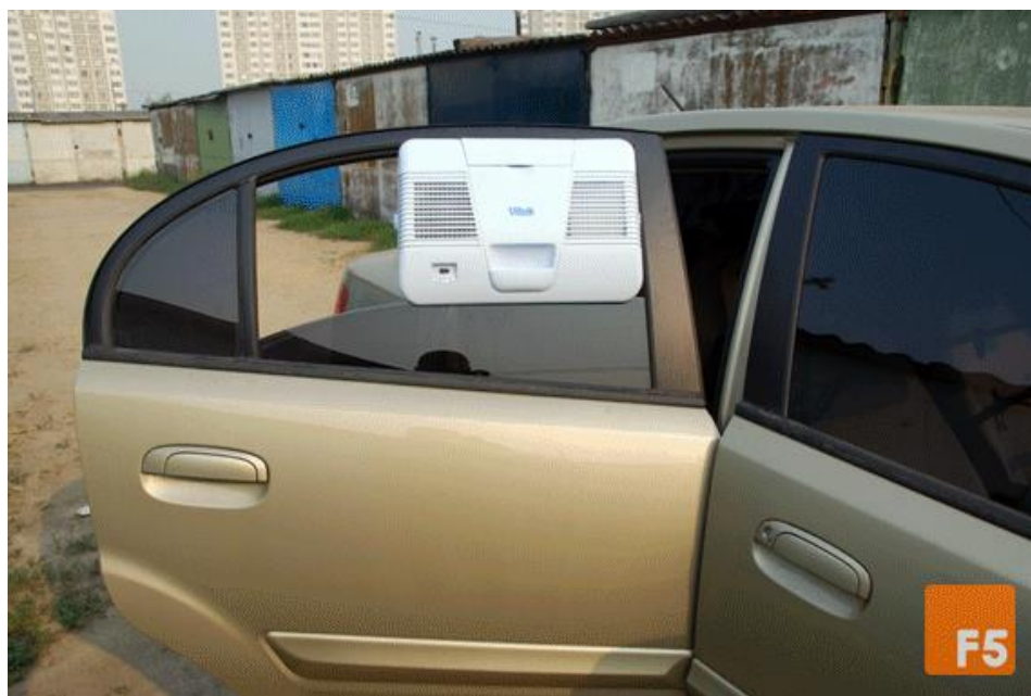
9-расм. Автомобил ойнасига ўрнатилган термоэлектрик кондиционер.
