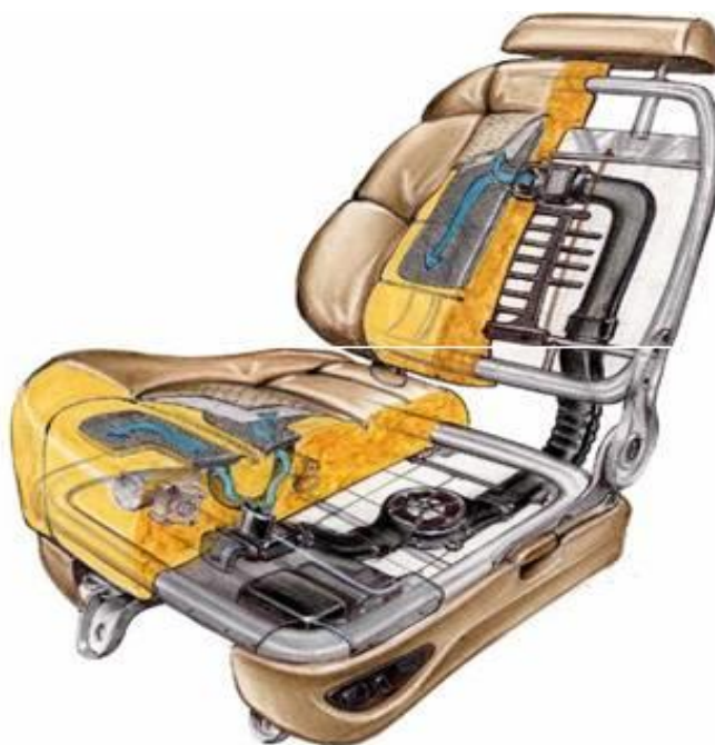
8-расм. Термоэлектрик модуль асосида ишловчи совитгич билан жиҳозланган автомобил ўриндиғи.
