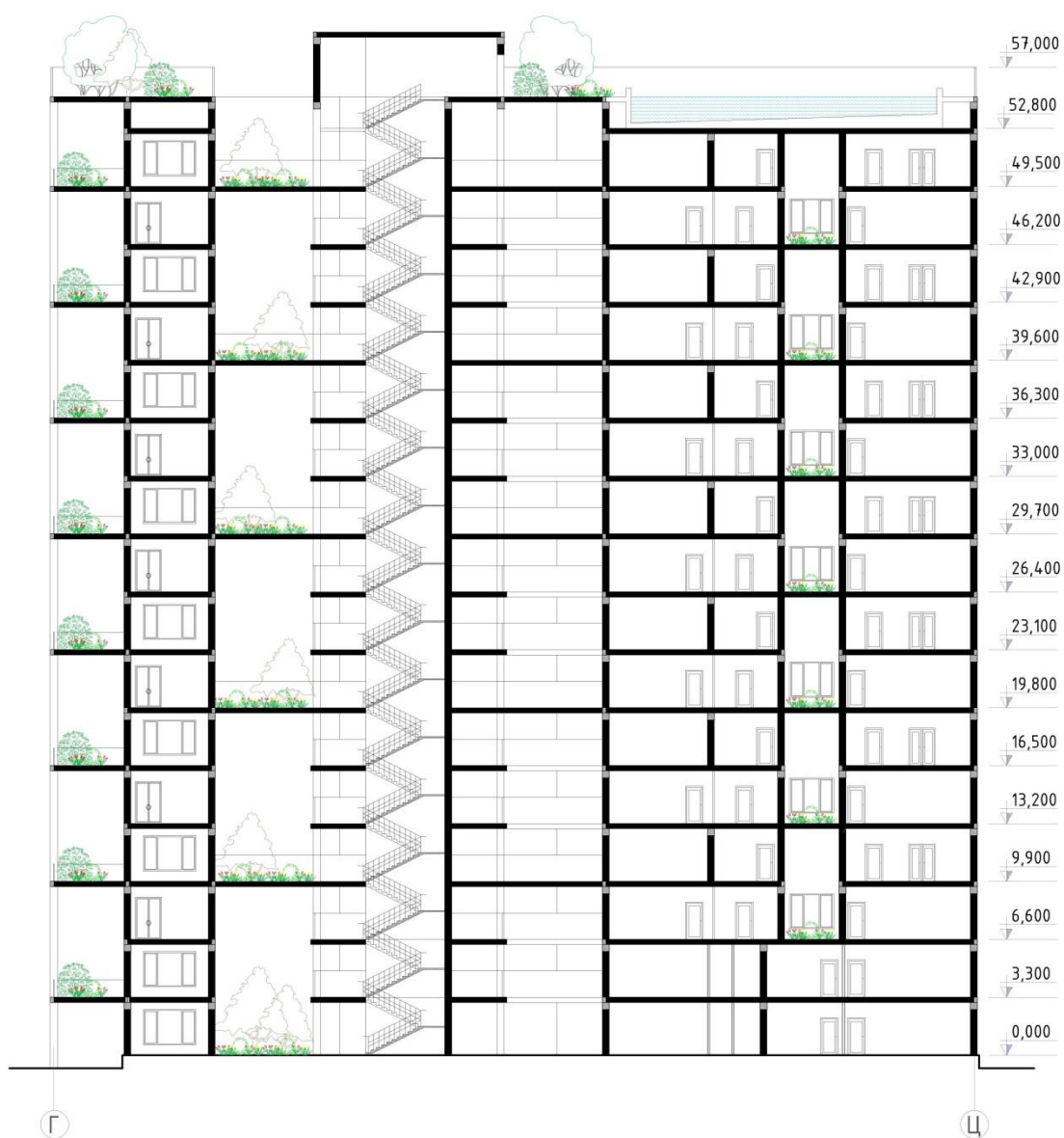
Рис. 3.4. Разрез жилого дома №1.
