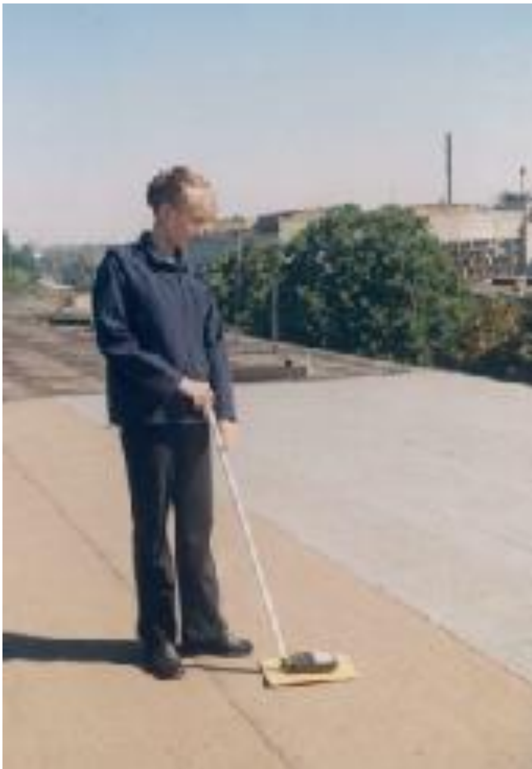
2.2 – расм. Дефектоскопнинг умумий кўриниши ва ишлатиш ҳолати
