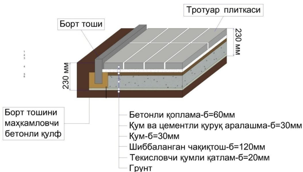
3.14-расм. Йўлакларнинг конструктив тузилиши
