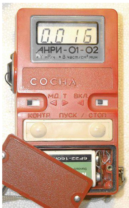
19.4 – Rasm. SBM -20 Geyger hiosblagichli «Sosna» dozimetr – radiometrining umumiy ko'rinishi
