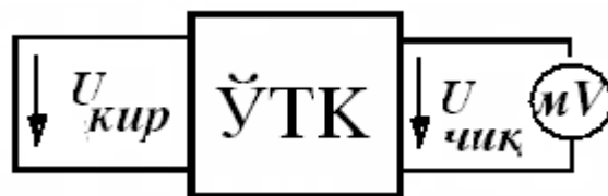
5.10–расм ўзгармас ток кучайтиргичи дрейфини ўлчаш схемаси.
