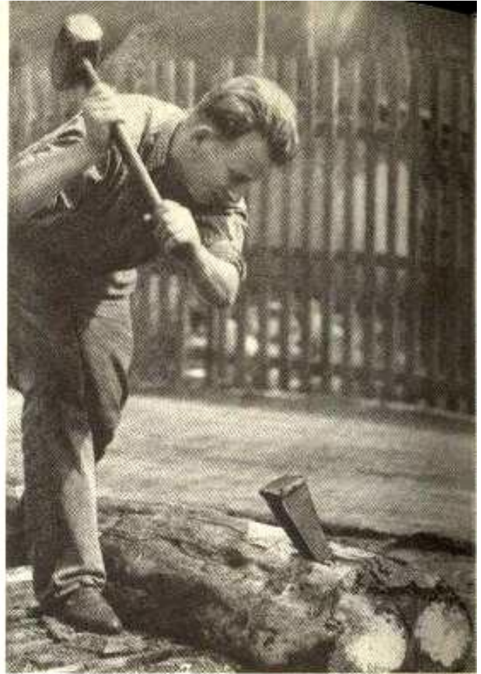
Keil als Spaltwerkzeug
