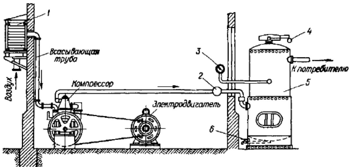
Рис. 9. Схема установки воздушного поршневого компрессора.
