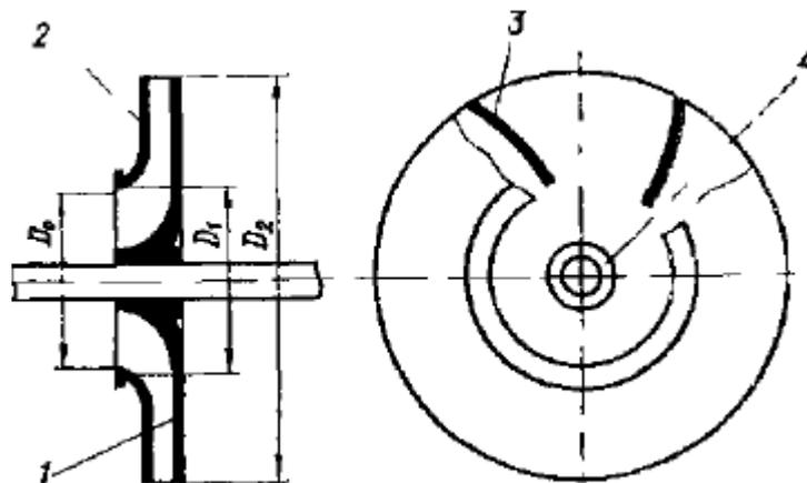
Рис. 6. Рабочее колесо.
