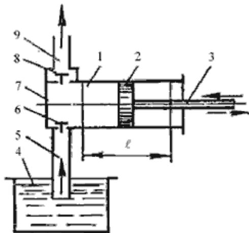
Рис. 1. Насос поршневой простого действия
