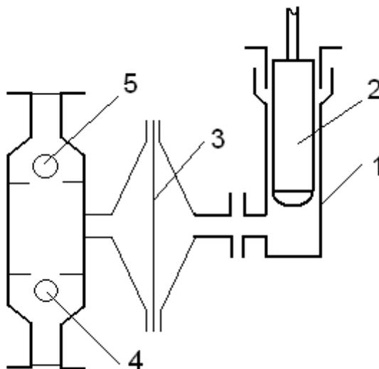
Рис. 4. Схемы диафрагменного насоса с плунжерным приводом диафрагмы
