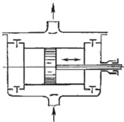
Рис. 3. Насос поршневой двойного действия
