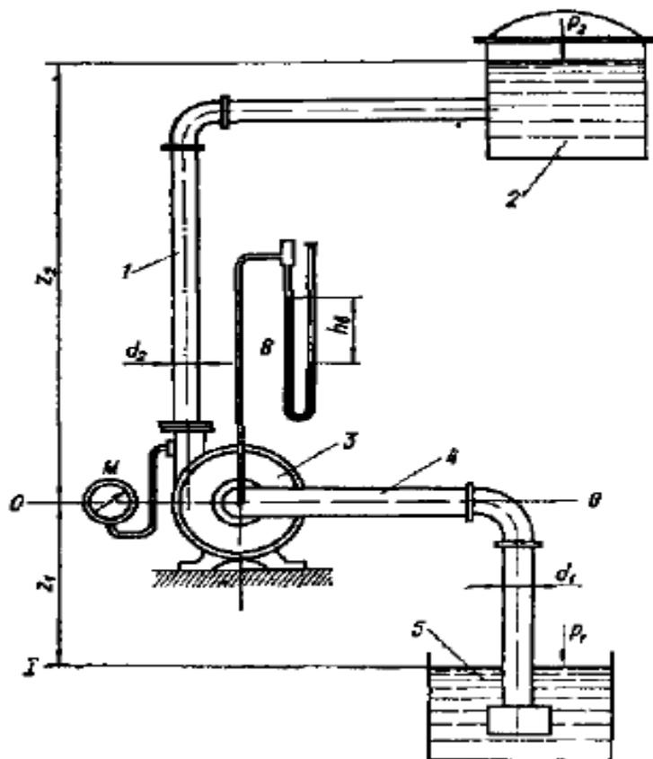
Поэтому манометрический напор, создаваемый насосом, можно выразить так:
