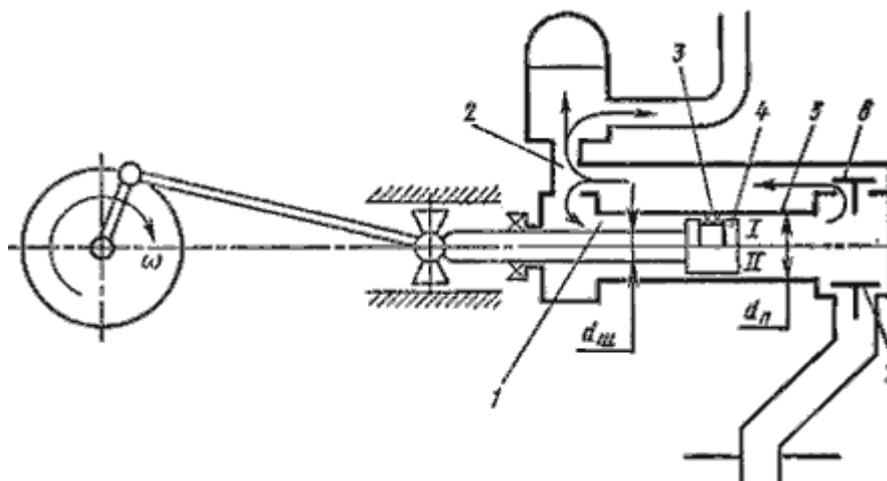
Рис. 2. Схема поршневого насоса с дифференциальным поршнем
