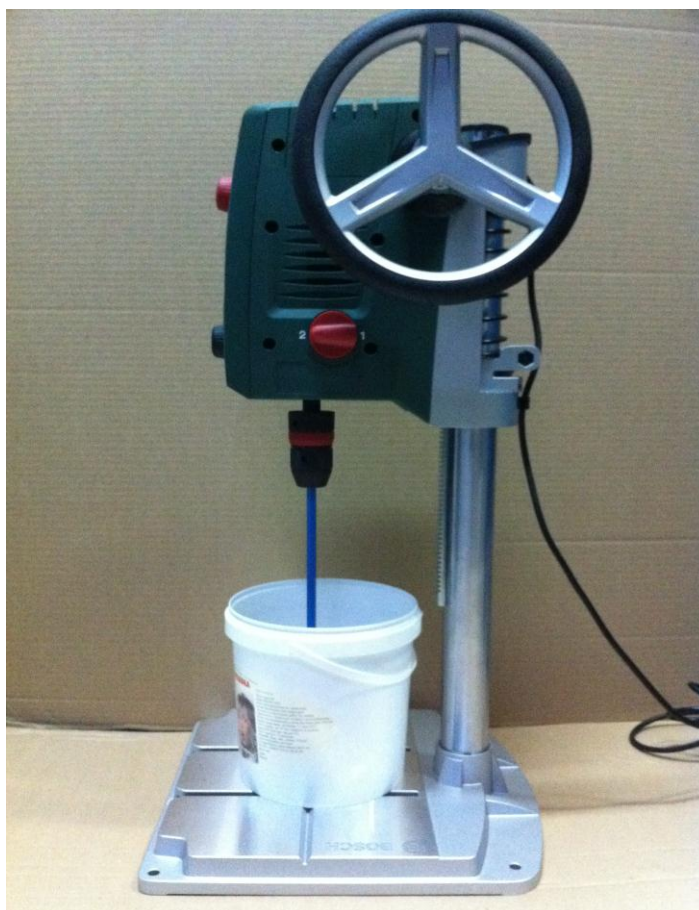
II.2-rasm. Dissolverning umumiy ko'rinishi.
