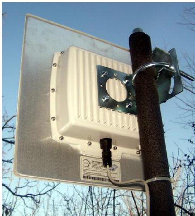
Рис. 1.1. ФАР EXAP-G19 – оптимальная клиентская станция широкополосного доступа 2.4 GHz, T.раб. \pm 60^{\circ} C
