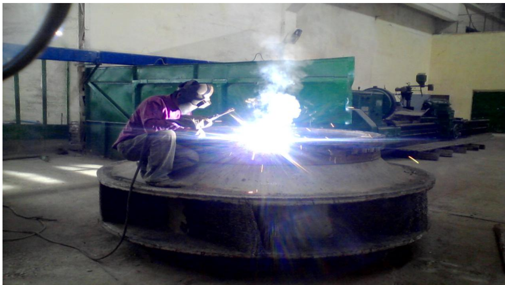
1.4-Rasm ishchi g'ildirakni ta'mirlash jarayoni
