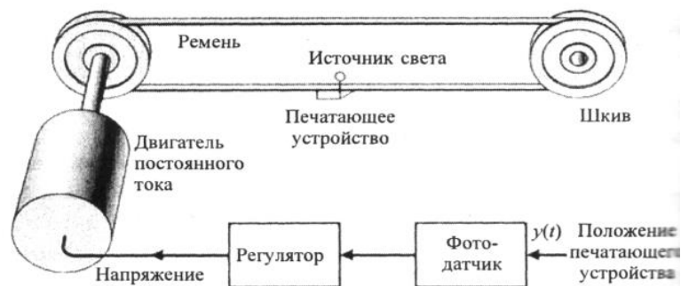
Рис.10. Ременный привод принтера
