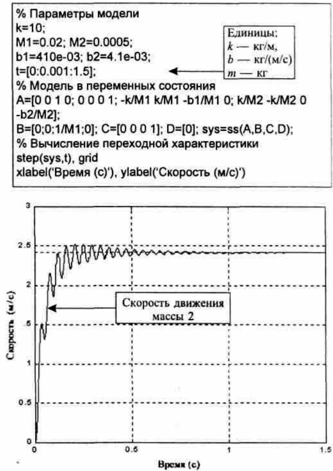
Рис. 17. Реакция переменной y на ступенчатое входное воздействие в модели с двумя массами при k = 10
