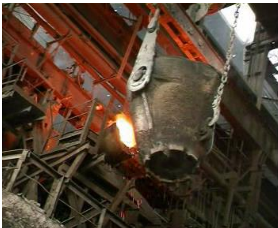
4.8 – rasm. Yallig' qaytaruvchi pechga converter shlakini quyish
