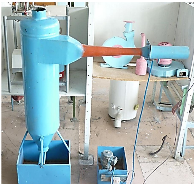
4.1-расм. Хўл усулда чанг ушловчи лаборатория қурилмаси.
