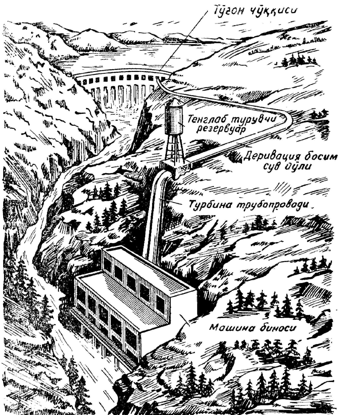
1.9—расм. Деривацион гидроэлектро станцияси.
