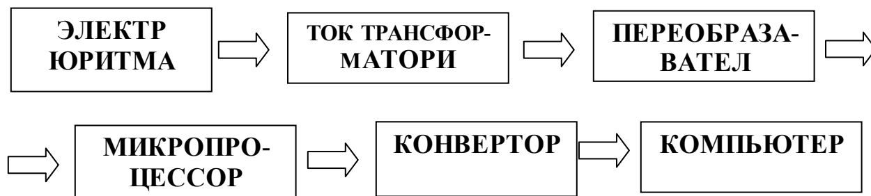
2.3 расм. Электр двигател ток нағрузқасини компьютер орқали назорат қилишни блок схемаси
