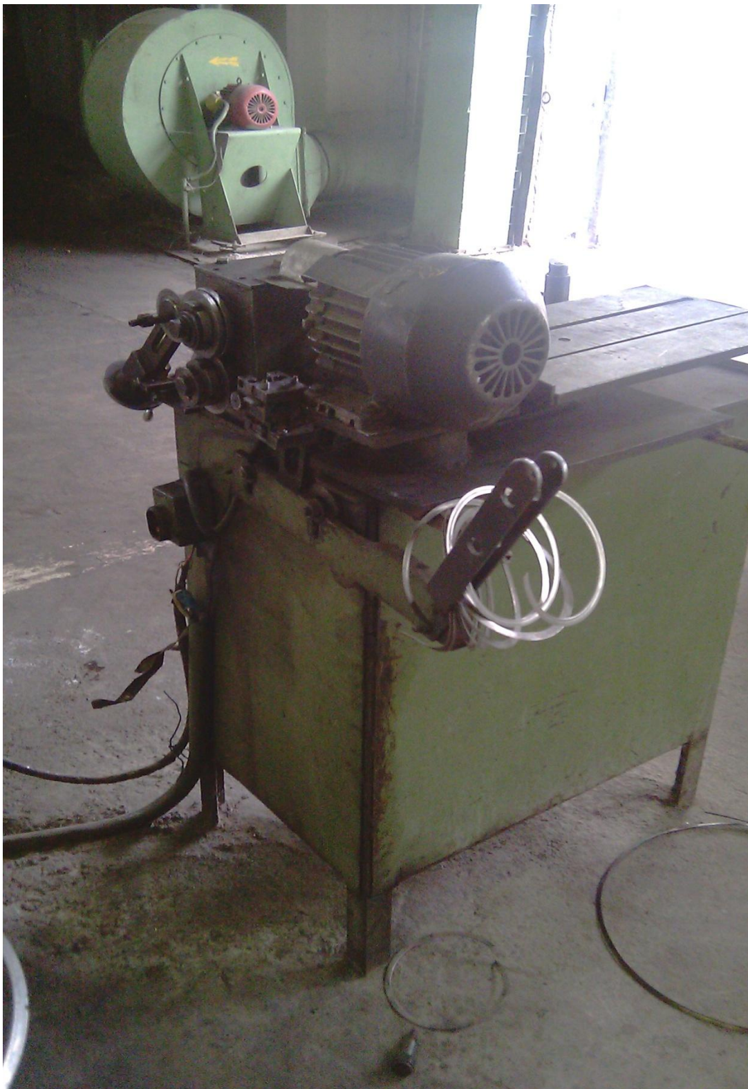
3.5а-расм. Лабиринтли тана зичлигичларини тайёрлаш ярим автомат жихозини умумий кўриниши.
