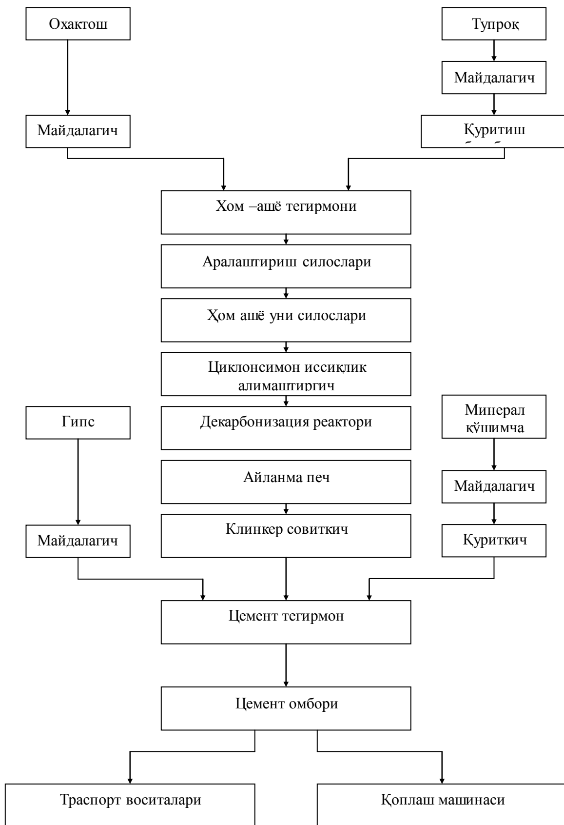
1.2 –расм. Цемент етиштиришнинг курук усули схемаси
