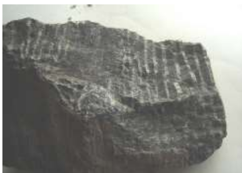
Rasm 5. Xrizotil-asbest tolalaridan hosil bo'lgan parallel tomirlar
