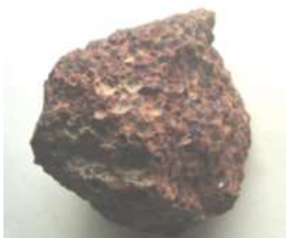
Rasm 11. Qo'ng'ir temirtoshning oolit strukturasini.
