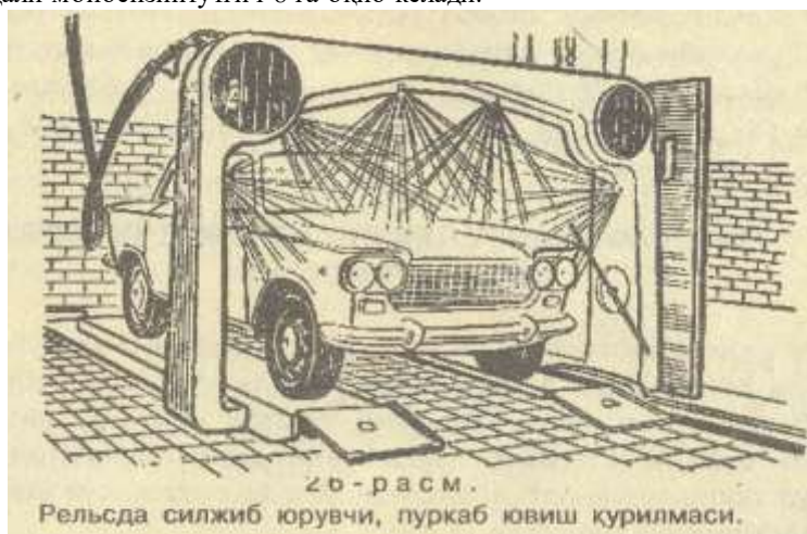
Рельсда силжиб юрувчи, пуркаб ювиш қурилмаси.
