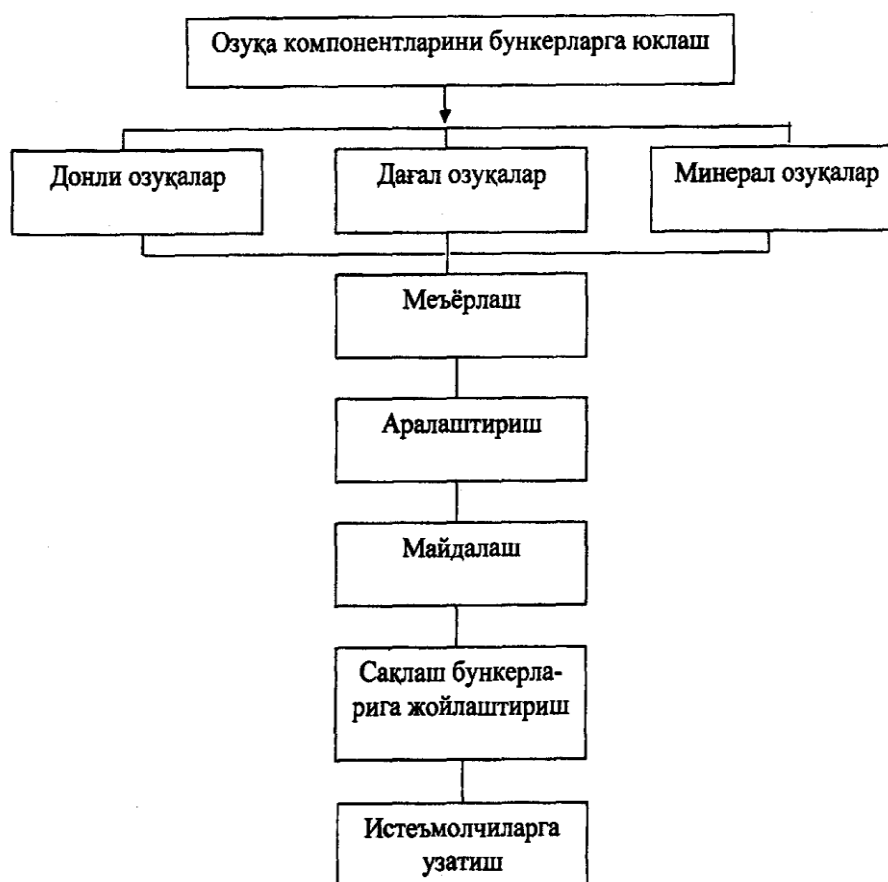
1.1-расм. Омухта ем тайёрлашнинг технологик схемаси
