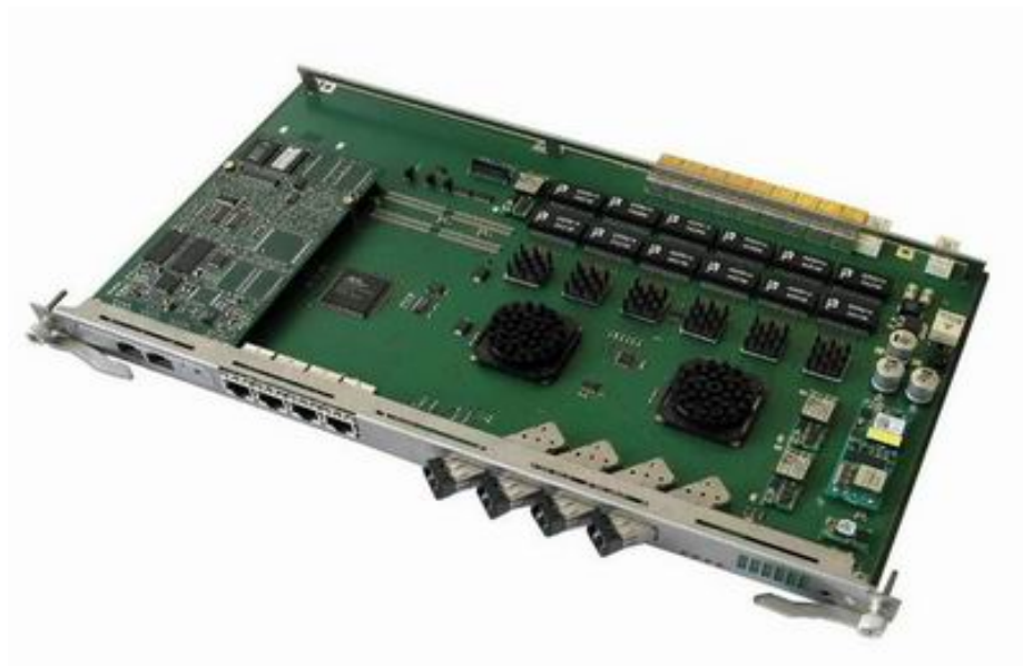
2.9 – rasm. Gigabit Ethernet agregatsiya platasining umumiy ko`rinishi
