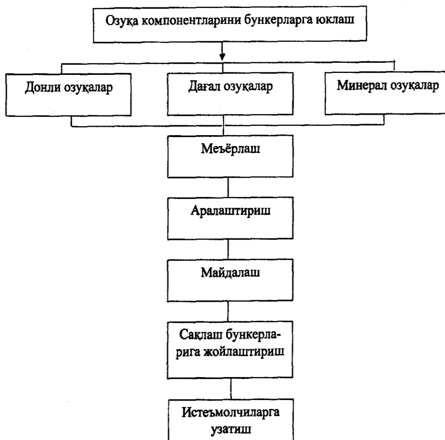
2.1-расм. Омухта ем тайёрлашнинг технологик схемаси
