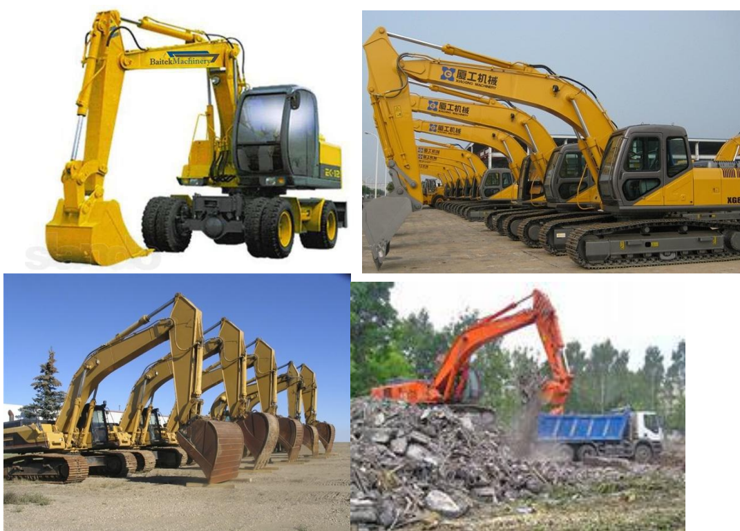
5.6-rasm. Ish jihozlari bikir osmali to'la aylanadigan bir cho'michli, teskari kurakli gidravlik ekskavatorlar; Bir cho'michli gidravlik ekskavatorlarning ish jihozlarining asosiy turlari: teskari kurak; b-maxsus moslama; to'g'ri kurak; g- greyfer; yuklagich.
