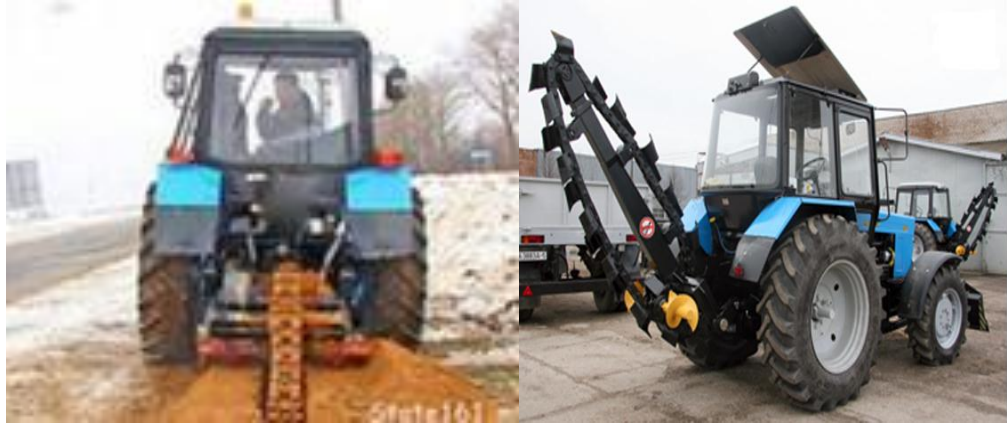
5.8-rasm. Zanjirli-shnekli konveyerga ega bo'lgan handaq ekskavatorlari: cho'michsiz; "Belorus" traktoriga osilgan qirg'ich; gusenitsali traktorga osilgan qirg'ichli.
