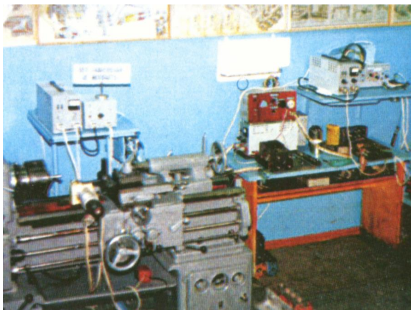
11-rasm. Tokarlik stanogiga o'rnatilgan „Elitron-52BM“ qurilmasining umumiy ko'rinishi.
