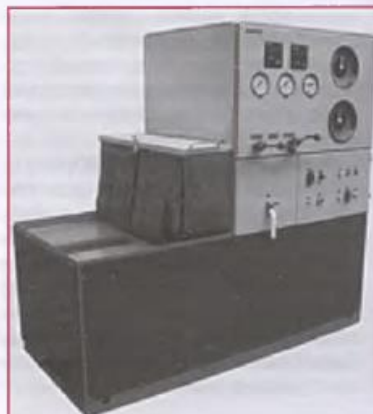
Рис. 1. Общий вид стенда КИ-28256.01 ГОСНИТИ для испытания насосов и фильтров системы смазки автотракторных дизелей
