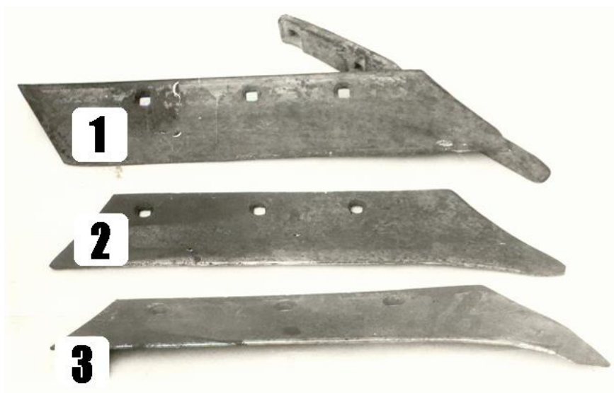
1-лемех ПЯШ-01.200; 2-лемех П-702; 3-лемех П-702 с изогнутым носком.
