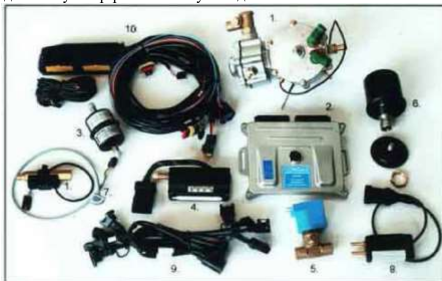
3.2-расм. Метан ёнилгисида ишловчи Longas (4-авлод газ баллон жих,озлари) номли алоҳида газ етказиш тизимининг асосий жих,озлари: 1-редуктор; 2-газ форсункаларини электрон бошқариш блоки; 3-газ филтри; 4-газ форсункаси (Ма1;пх); 5-газ клапани; 6-тулдириш клапани; 7-улагич; 8-босим датчиги.
