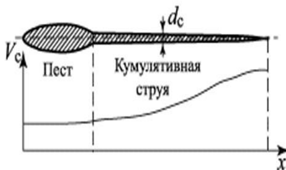
Рис. 2.4. Распределение скорости частиц вдоль кумулятивной струи
