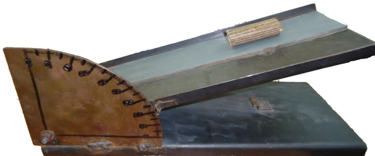
3.2-расм. Топинамбур пояси ва пластмасса орасидаги ишқаланиш бурчагини аниқлаш.
