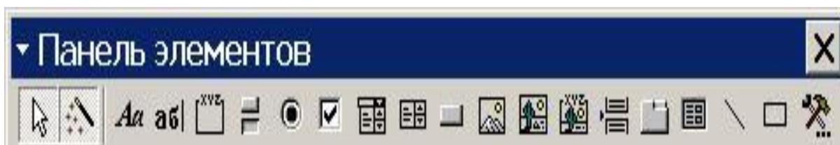
Программисту необходимо установить на форме требуемый элемент управления нажатием соответствующей кнопки на панели элементов и "протяжкой" указателем мыши в нужном месте формы.
