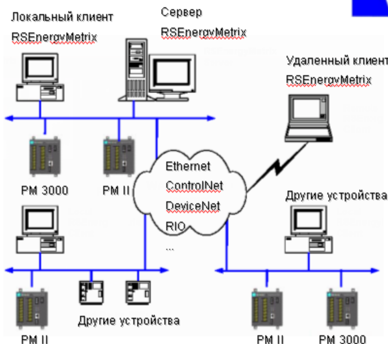
Рисунок 4.1 – Пример сети с использованием RSEnergyMetrix
