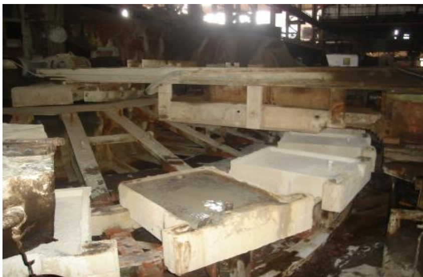
11.2-расм. Анод печи ёнига ўрнатилган бўлиб, суюқ эритмани айланма “карусель” қолип орқали қуйиш агрегати.
