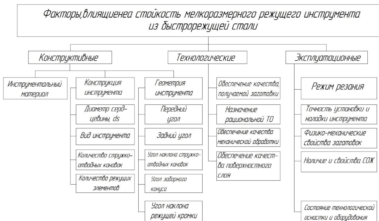
Рис.1. Факторы, влияющие на стойкость осевого мелкогазмерного режущего инструмента из быстрорежущей стали
