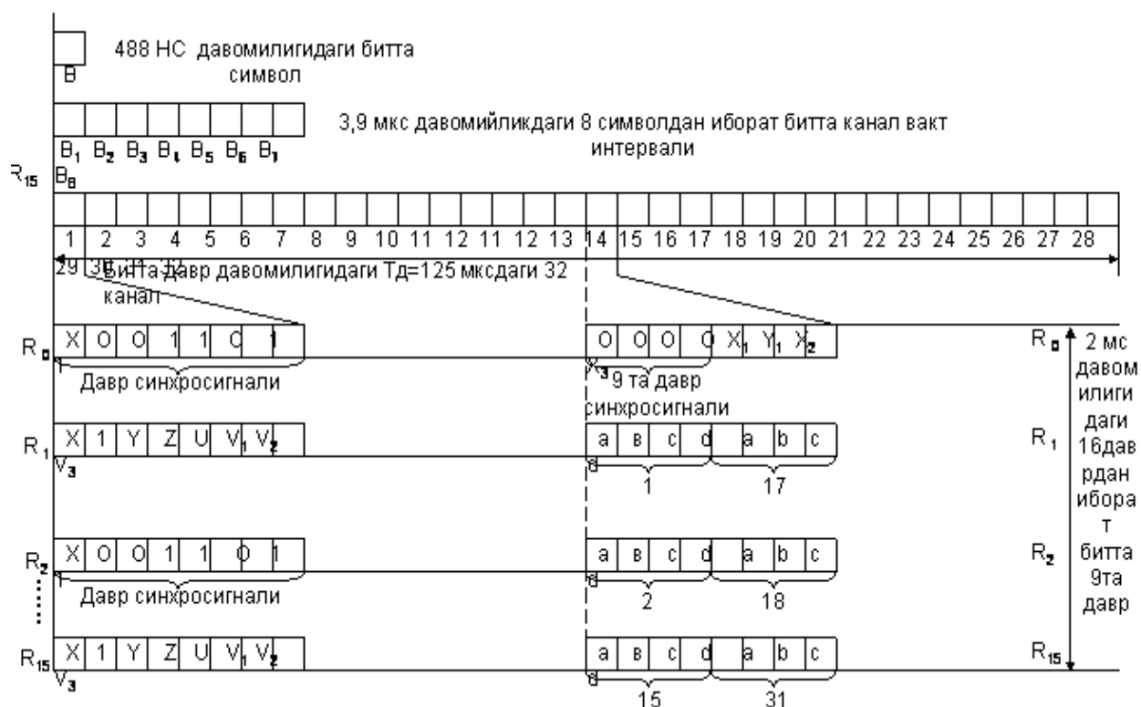
4.2 - расм. ИКМ – 30 тизими давр ва утадавр вақт тузилмаси.
