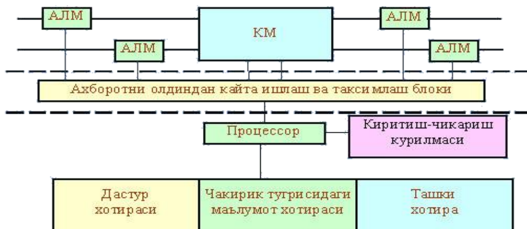
5.1. расм. Марказлаштирилган дастурли бошқаришли ЭАТС
