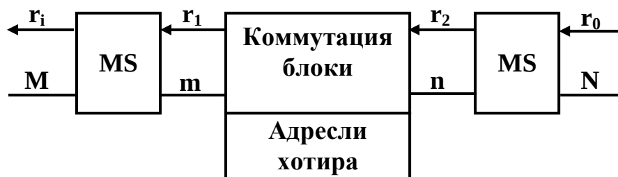
8.9-расм. Вақт бўйича бўлинган коммутация звеносининг модели
