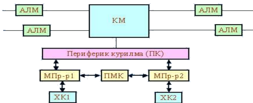
5.2. расм. Иккимашинали бошқарув комплекси.
