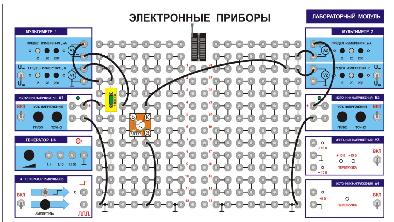
2-расм. Умумий эмиттерни схемадаги транзисторнинг статик характеристикаларини олиш учун уланишлар схемаси.
