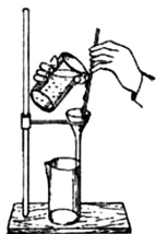
8-rasm. Filtrlash: a) filtrlash qurilmasi; b) shisha voronkalari.
