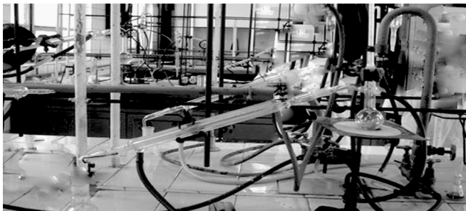
2-rasm. Etil iodid hosil qilish uchun ishlatiladigan qurilma.
