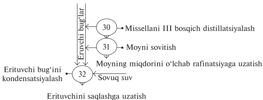
3-rasm. Paxta chigitidan forpress-ekstraksiya usulida moy olish sxemasi.
