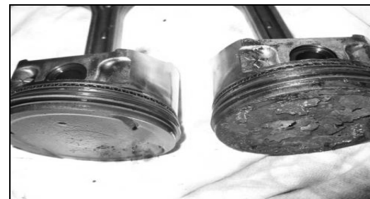
2.12-rasm. Porshenlar tubida smola va qurum hosil bo'lishi.
