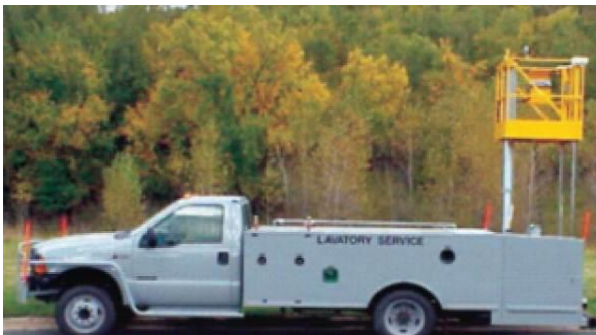
2.4-rasm. Samolyotning xojatxonasi xizmati mashinasi "STINAR SLV"
