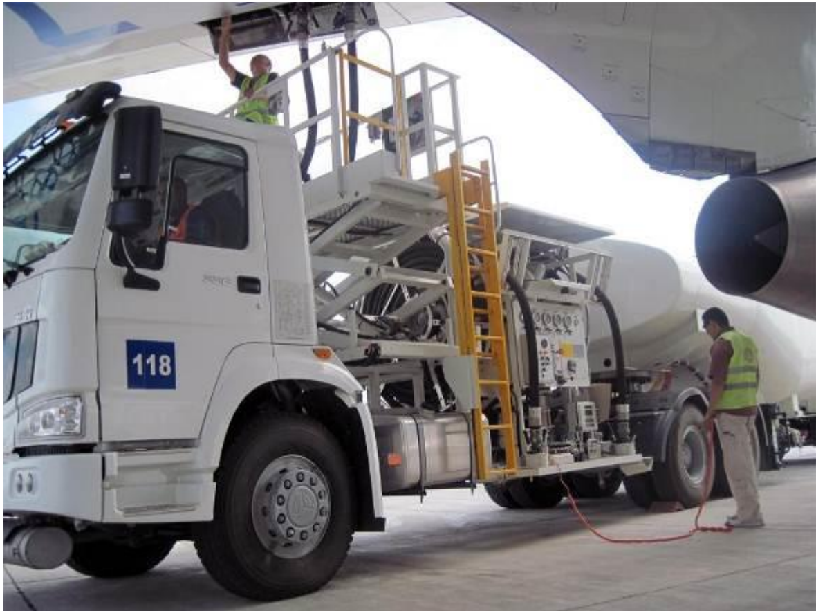
2.23-rasm. Havo kemasiga yoqilg'i quyish mashinasi "RFT 20"
