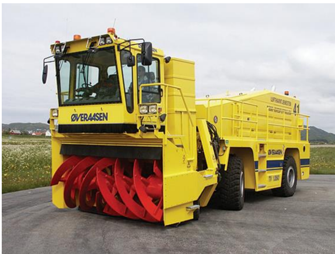
3.11-rasm. Frezer-rotorli qor tozalash mashinasi “TV-2000”
