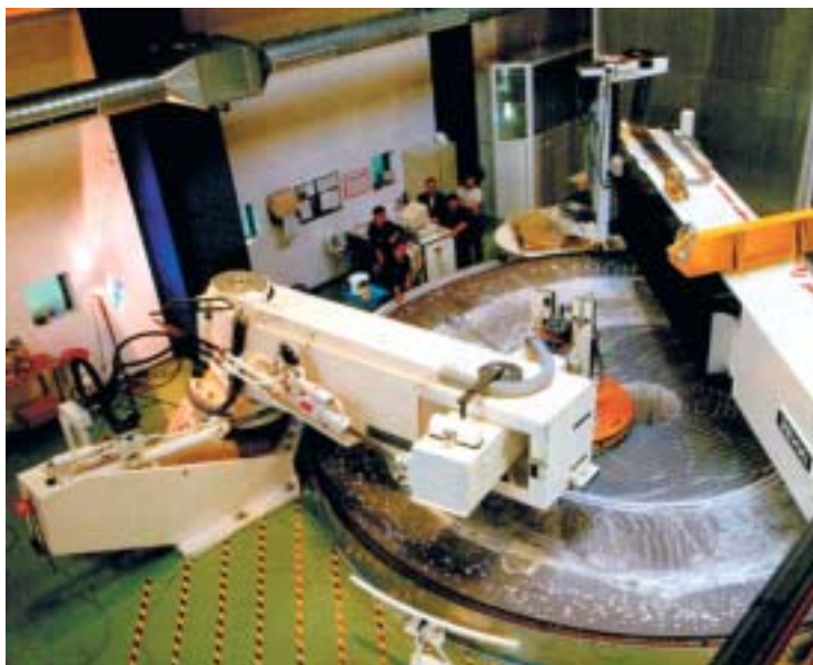
56- rasm. Diametri 8 metrli teleskop ko'zgusiga sexda sayqal berish jarayoni.
