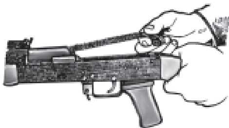
99-rasm. Qaytaruvchi mexanizmni ajratish.
