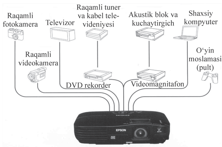
26- rasm. «Epson» proyektorlarini axborot kanallariga ulash.
