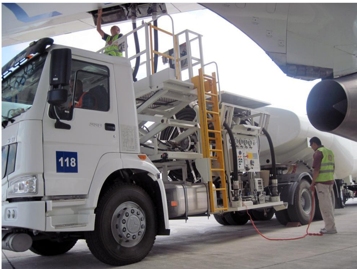
2.23-rasm. Havo kemasiga yoqilg'i quyish mashinasi "RFT 20"
