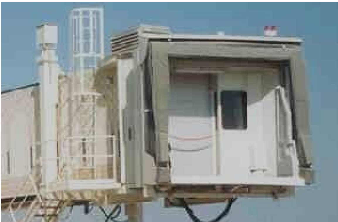
2.3-rasm. Yo'lovchilar teleskopik traplari.
