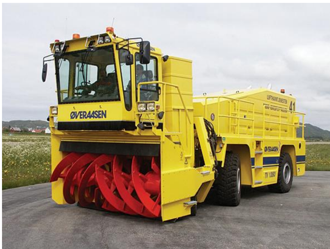
3.11-rasm. Frezer-rotorli qor tozalash mashinasi “TV-2000”
