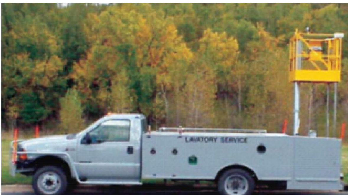
2.4-rasm. Samolyotning xojatxonasi xizmati mashinasi "STINAR SLV"
