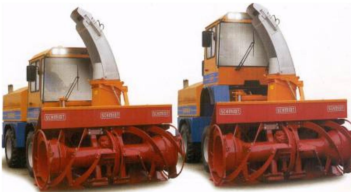
3.10-rasm. Rotorli qor tozalash mashinasi "SUPRA 4001"
