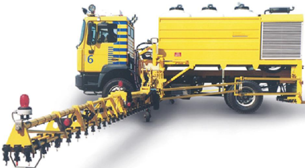
3.12-rasm. Aerodrom yo'laklarini muzlashni oldini oluvchi mashinasi "ASP"
