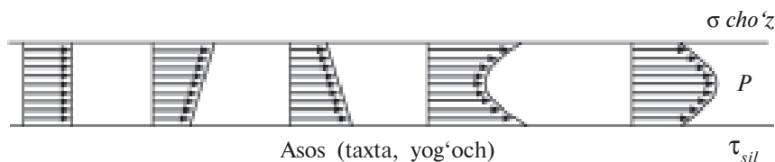
10-rasm. Parda qatlam qalinligi bo‘yicha normal ichki kuchlanishlarning mumkin bo‘lgan joylashish variantlari.
